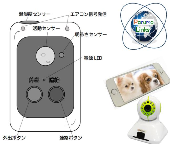
パルモ 見守り番 Safety Finder iSS-200 は本機のセンサーの情報やボタンが押されたことをWiFi (無線LAN) からインターネットを通じてクラウドに送信します。クラウドでは、その変化をグラフで提供します。また、温度が適正外だったり、活動量が一定時間無いなどの状況で、予め登録された、相手先にメールや音声 (オプション) で通報します。エアコンの遠隔制御が行えます。パルモシリーズとの組合わせで映像確認や声かけを行うことができます。
