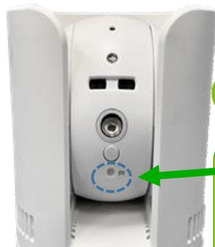
ACアダプタを電源ジャックに挿し、電源に繋げると電源が入ります。
