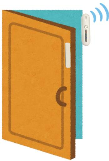
ドアセンサーは本体とマグネットがくっついている状態から離れる（ドアが開く）と、センサーが反応します。付属のネジまたは両面テープで、図のようにドアに取り付けてください。
