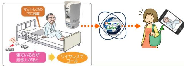
マットレスの下に置き、ベッドからの起き上がりや移動を検知します。その変化を通知します。
