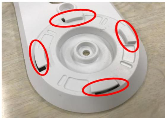
②本体の裏側のへこみと、取付保持具の出っ張りがかみ合うようになっています。出っ張りとへこみを合わせて差し込んでください。差し込んだ後、矢印の方向に最後までしっかりと回してください。その際、下の土台部分を持って回してください。（上を持って回すとカメラが回ってしまうため）
