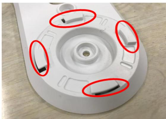
本体の裏側のへこみと、取付保持具の出っ張りがかみ合うようになっています。出っ張りとへこみを合わせて差し込んでください。差し込んだ後、矢印の方向に最後までしっかりと回してください。その際、下の土台部分を持って回してください。（上を持って回すとカメラが回ってしまうため）
