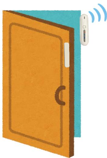
ドアセンサーは本体とマグネットがくっついている状態から離れる（ドアが開く）と、センサーが反応します。付属のネジまたは両面テープで、図のようにドアに取り付けてください。接着面がざらざらしている場合や接着に不安がある場合は、ネジ止めにて固定をお願いします。
