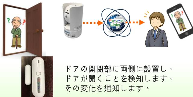
ドアの開閉部に両側に設置し、ドアが開くことを検知します。その変化を通知します。
