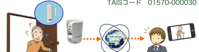
磁気近接センサーにより、ドアや窓が開くことを検知します。その変化を受信して、スマホやタブレットに通知し、即座に遠隔から映像確認と声かけができます。徘徊の可能性のある高齢者を守ります。
