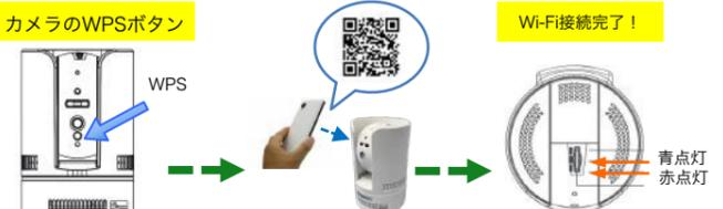
カメラのWPSボタンを押すと上部のLEDが3色に交互点滅を始めます。スマホのアプリ画面にQRコードが表示されるので、カメラに読み取らせます。カメラの上部のNetwork LEDが青、Status LEDが赤点灯すれば接続完了です。
